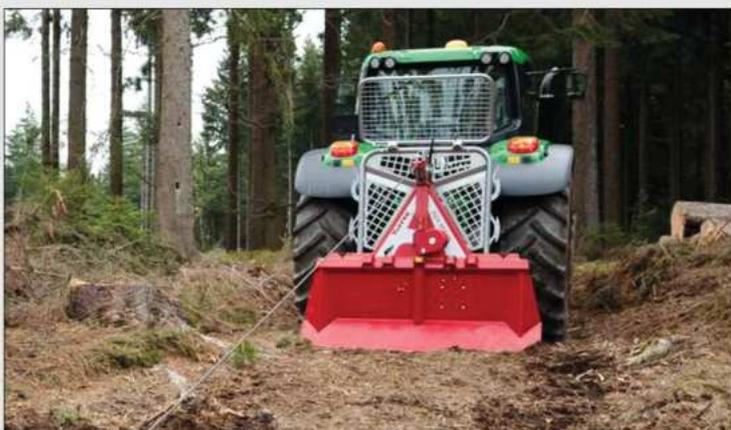
mit mechanischem oder hydraulischem Antrieb
