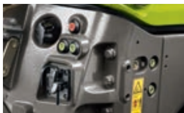
Externe Bedienung für den Frontkraftheber und ein Steuergerät mit CEBIS Ausstattung
