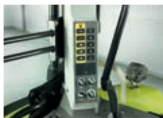
Zapfwellengeschwindigkeiten und elektronische Hubwerksregelung am B-Holm einstellbar
