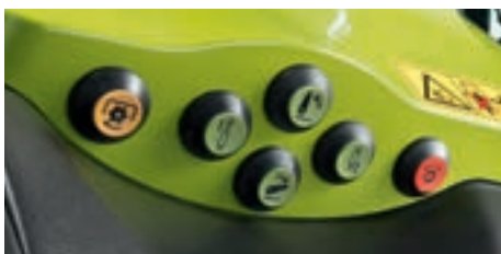
Externe Bedienelemente für den Heckkraftheber, die Zapfwelle und ein wählbares Steuergerät (nur CEBIS)
