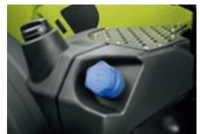
455-l-Kraftstofftank mit eingelassenem 42-l-Harnstoffvorrat
