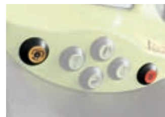
Externe Bedienung für Heckzapfwelle an beiden Kotflügeln
