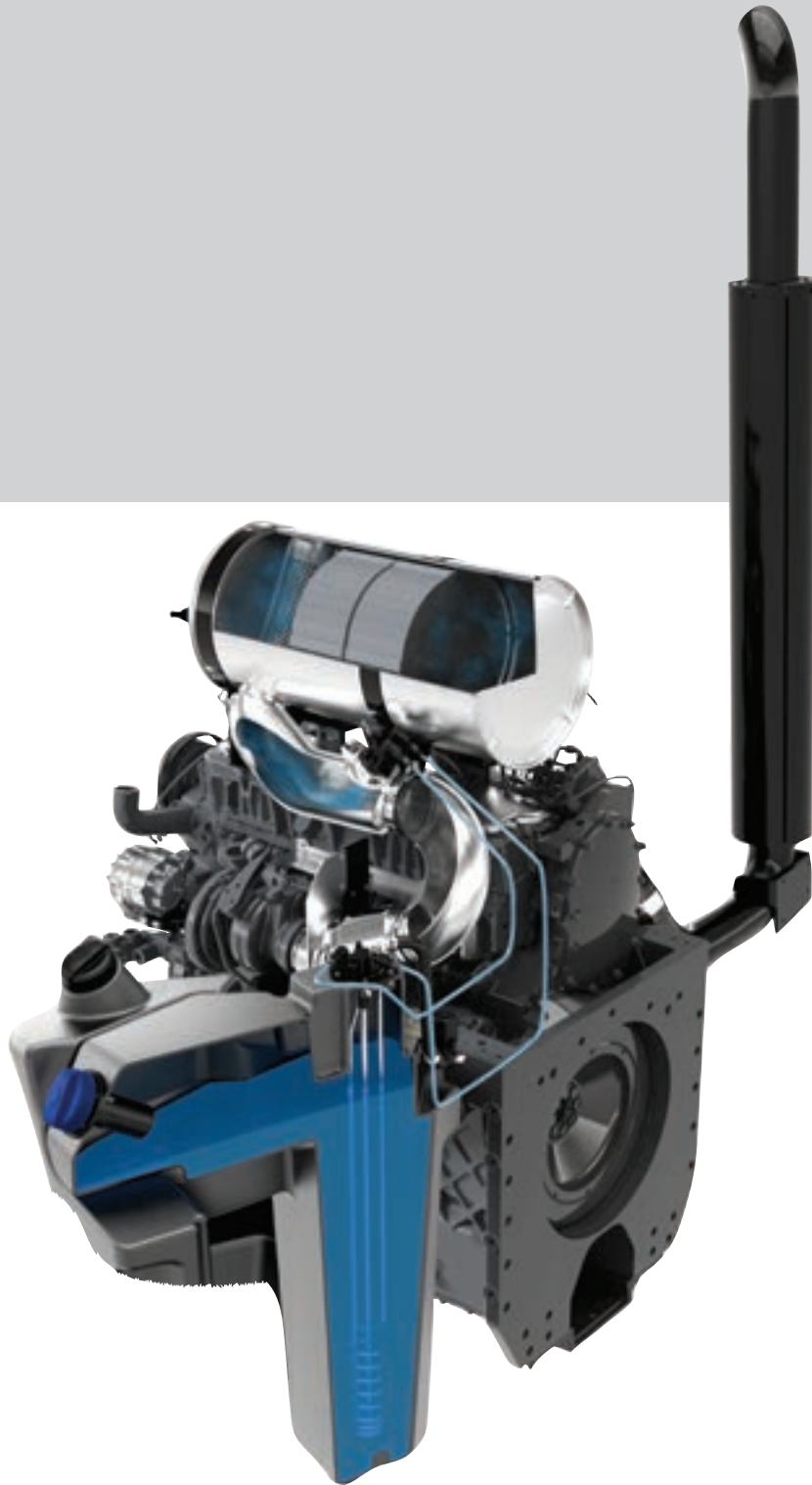
700-l-Kraftstofftank mit eingelassenem 60-l-Harnstoffvorrat
