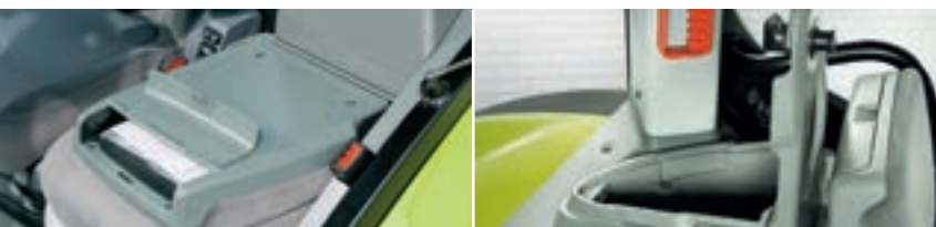
Dokumentenbox und abnehmbare Staubbox in linker Konsole
