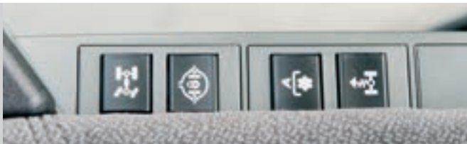
Bedienfeld (11) in der Armlehne: Allrad, Differentialsperre, Zapfwellenautomatik und Vorderachsfederung
