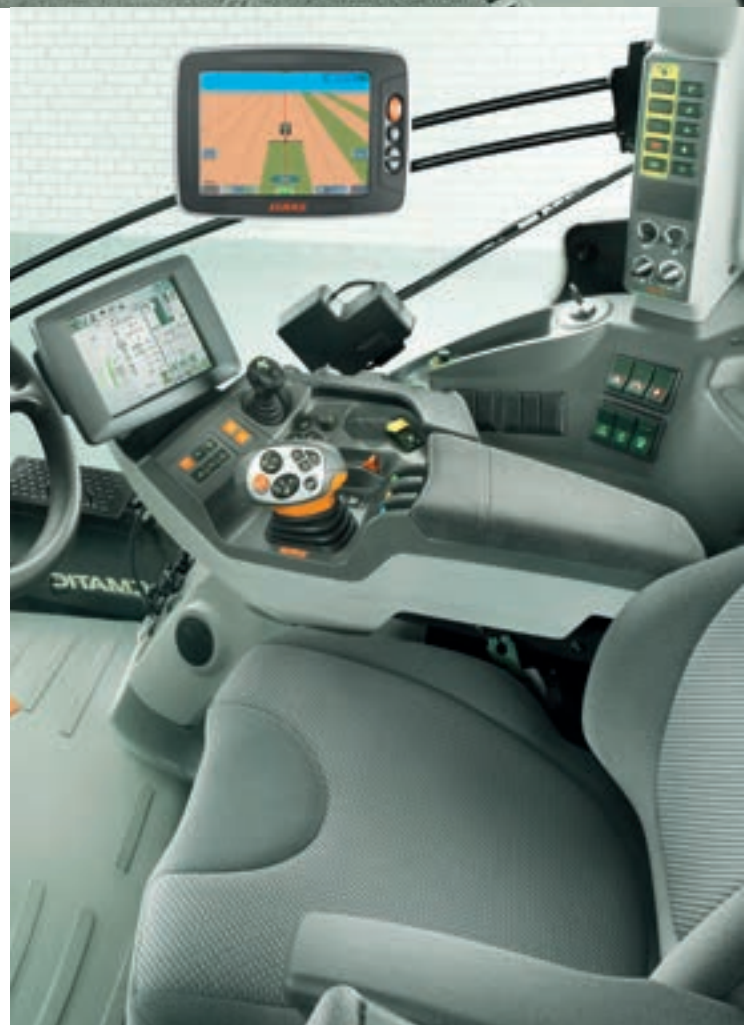
Bedienfeld (11) in der Armlehne: Allrad, Differentialsperre, Zapfwellenautomatik und Vorderachsfederung
