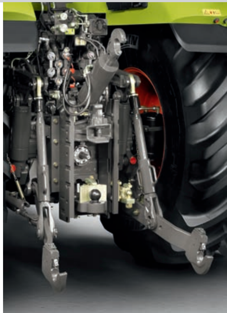
Externe Bedienelemente für den Heckkraftheber, die Zapfwelle und ein wählbares Steuergerät
