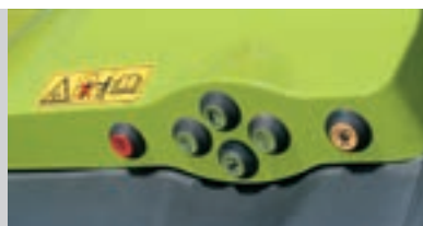
Externe Bedienelemente für den Heckkraftheber, die Zapfwelle und ein wählbares Steuergerät
