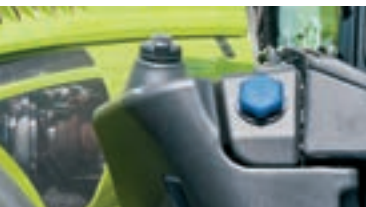
700-l-Kraftstofftank mit eingelassenem 60-l-Harnstoffvorrat
