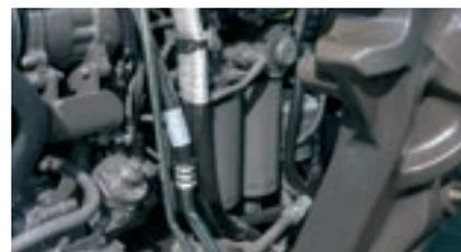
Die Ölfilter am Motor sind auch mit Frontladerkonsolen gut erreichbar.
