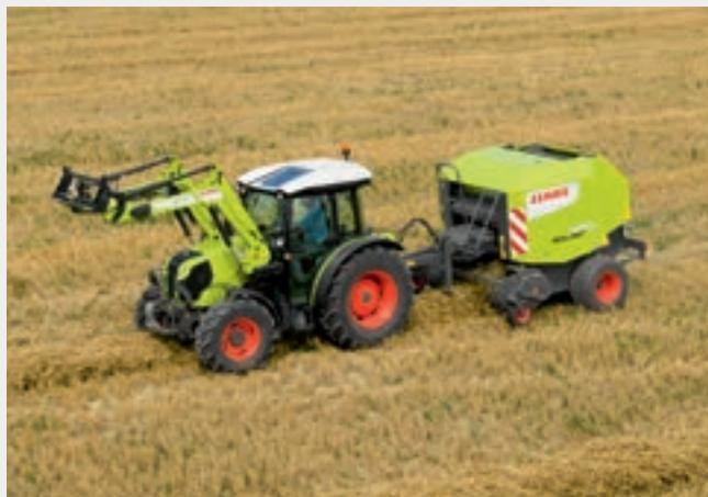
Vier Modelle mit 75, 85, 92 sowie 103 PS bilden die ELIOS Baureihe. Das Spitzenmodell erreicht die 103 PS durch CLAAS POWER MANAGEMENT. Spritzige und sparsame 4-Zylinder-Common-Rail-Motoren von FPT bieten einen ruhigen Lauf und ein sattes Drehmoment.
