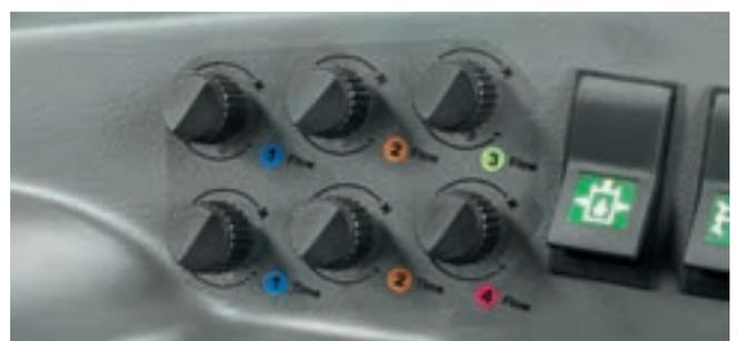
Die Zeit- und Mengenregelung der vier elektronischen Steuergeräte ist jederzeit über die Drehregler steuerbar. Damit können auch Senk- und Kippgeschwindigkeit des CLAAS Frontladers eingestellt werden.
