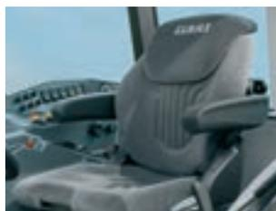
Der neue Komfortsitz ist mit Luftfederung, einer dicken Stoffpolsterung und einer ausziehbaren Rückenstütze ausgestattet.
