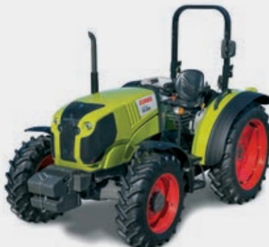
Aber auch die Plattformversion des ELIOS ohne Kabine hat einiges zu bieten. So ist der Überrollbügel klappbar, was die Durchfahrthöhe auf gerade einmal 1,92 m reduziert. Mit dem optional nach unten gerichteten Abgasrohr kommt der ELIOS damit selbst in niedrigste Gewächshäuser, Gebäude und Plantagen.
