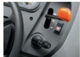
Für das 24-Gang-Getriebe gibt es wahlweise eine mechanische Untersetzung rechts neben dem Lenkrad oder die komfortable TWINSHIFT Zweifachlastschaltung, die am Gangschalthebel bedient wird.
