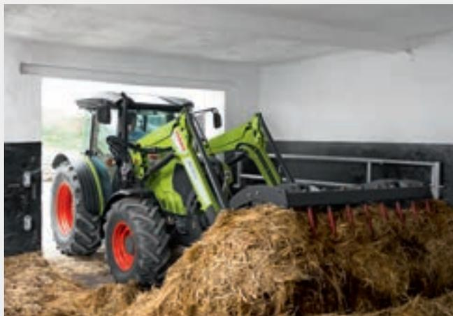
Bei einer minimalen Gesamthöhe ab 2,43 m mit Kabine – nur 1,92 m mit Plattform und eingeklapptem Überrollbügel – und einem Wenderadius von nur 3,47 m ist der ELIOS bestens für den Einsatz in engen Stallgebäuden oder Gewächshäusern geeignet.
