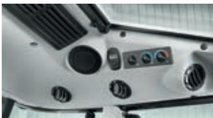
Die Heizungs- / Lüftungsanlage bietet ein vierstufiges Gebläse und zahlreiche einstellbare Luftdüsen. Eine regelbare Klimaanlage ist ebenfalls erhältlich.
