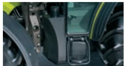
Das einfache Betanken mit Diesel ermöglicht der Einfüllstutzen am linken Kabineneinstieg.
