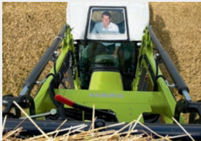
Ideal für Frontladerarbeiten ist die REVERSHIFT Wendeschaltung in Kombination mit dem elektronischen ELECTROPILOT Kreuzhebel zur Bedienung von zwei Steuergeräten. Das Glasdach bietet zudem eine optimale Sicht auf den ausgehobenen Frontlader.
